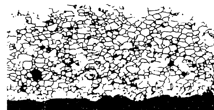
图2 典型的晶间腐蚀照片
