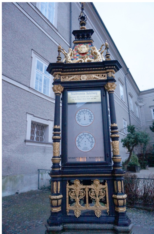
这座位于奥地利萨尔茨堡市的19中后期气象站，在2007年被选为历史地标。右图为其显示相对湿度的侧面。这个时代的湿度计常常用人类头发的张力度量，头发的张力会根据空气中的湿气含量不同而改变。
